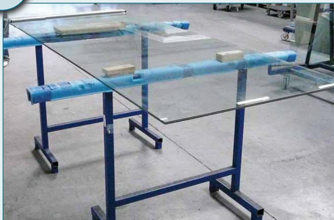
Сборку створок лучше производить на 2 - х козлах. Опорная поверхность которых должна быть покрыта мягким материалом во избежание повреждения профиля и стекла.
