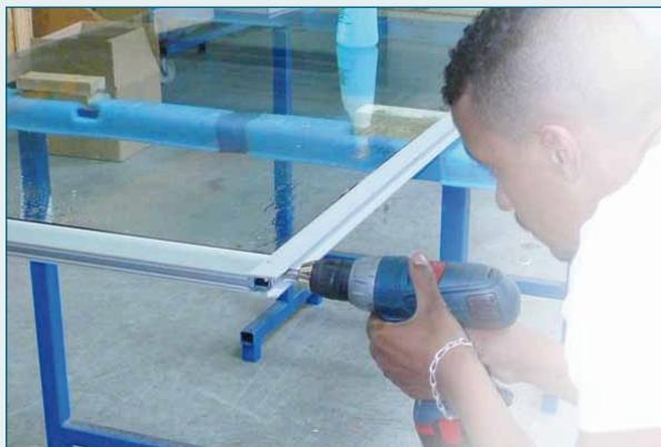
**4.7** Закрепите вертикальный профиль винтами. Проверьте геометрические размеры створки и протяните винты.
