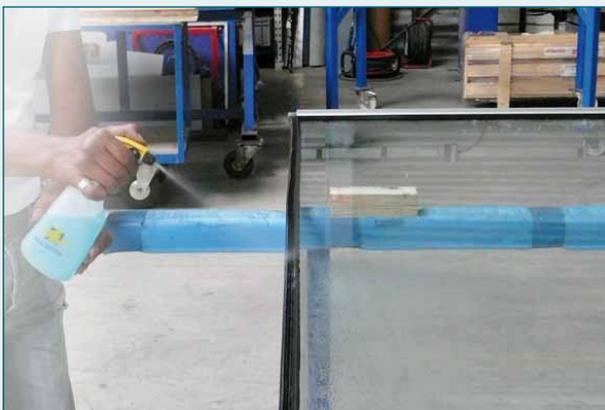
**4.3** С помощью распылителя нанесите мыльный раствор на уплотнительную резину сверху и снизу.
