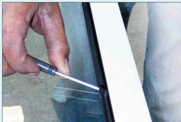
**4.9** Установите торцевой уплотнитель, щеточный уплотнитель, крепеж к каретке, нащельник с щеткой, протрите створку и упакуйте.
