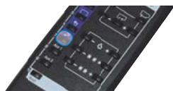
Нажимая на кнопку последовательно можно выбрать тип звукового сигнала или отключить его.
